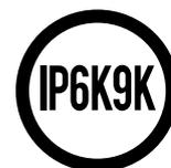
Le format de l'indice, donné par la norme CEI 60529, est IP6K9K où les caractères 6 et 9 sont deux chiffres et/ou une lettre. Les chiffres indiquent la conformité avec les conditions résumées dans les tableaux ci-dessous. Le tableau des indices comporte un nombre de 2 chiffres : 1er chiffre signifie protection contre les solides et 2e chiffre signifie protection contre l'intrusion d'eau.
